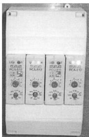
Рис. 4. Блок управления режимом работы микроволнового модуля
